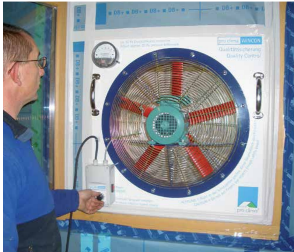
Zkušební ventilátor WINCON se instaluje do okna nebo dveří. Podtlak, který vznikne v budově, pomůže rozpoznat netěsnosti.
