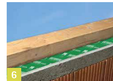
6 Použití pod okapovou vaznicí Pásku lze též použít jako izolační vrstvu na ochranu dřevěných stavebních dílů, jako jsou prahy nebo okapové vaznice, před vztlínající vlhkostí z betonových stavebních dílů (základová deska, věnec atd.)
